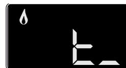
Attendre 1 minute pour que la chaudière se stabilise avant de réaliser les analyses de combustion.
